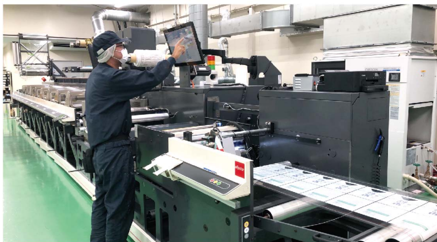
フレキソ印刷機（ニールピーター）水性インキ/UVインキ対応で環境や人にやさしい
