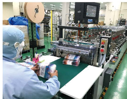
製袋機 （New IWASHO：三方機・合掌機の計2台） 三方機においては、チャックやスタンドの取り付けも可能
