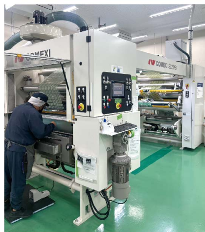
ラミネート機（COMEXI） ノンソルベント方式を採用しており、VOC（揮発性溶剤）の発生がなく環境や人体に優しい
