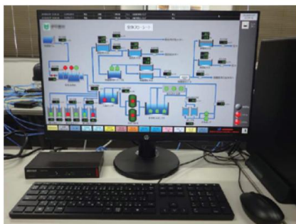
プラント監視制御システム
