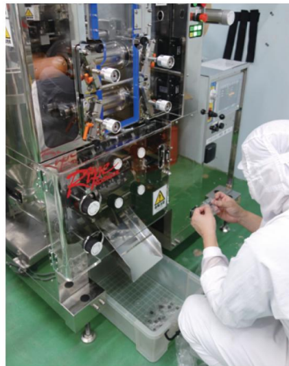
小袋充填機での充填作業
