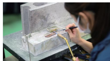
ロウ付け作業
