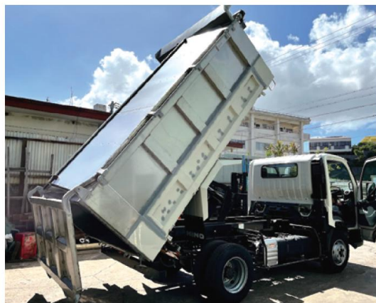
通常ダンプをステンレスにて嵩上げ、密閉用に製作した車両
