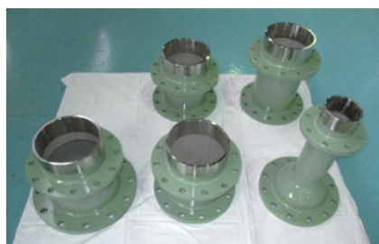
水道管／重防食塗装
