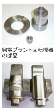
ボールバルブの軸製品 SUS316L
