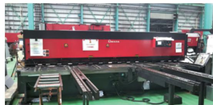
2019年8月(株)アマダ社製メカニカルシャーリングマシンM4065リターンショートコンベア付
