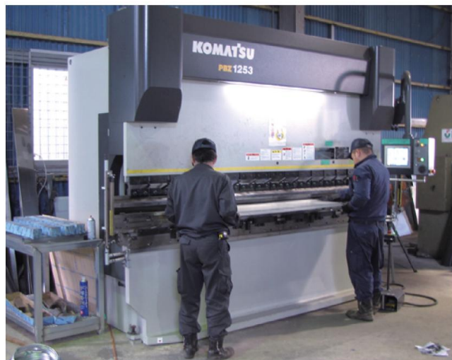
プレスブレーキPBZ1253E (コマツ製)
